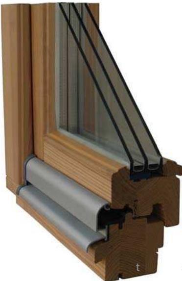
Die Rahmen bestehen aus dreifach verleimten und imprägnierten Bauteilen und sind an den wetterempfindlichen Stellen mit Aluminiumleisten überdeckt. Die Türen können wahlweise entweder mit einem Beschlag für beidseitige Verriegelung oder mit einem Dreh/Kipp-Beschlag (Tilt-First) geliefert werden.
